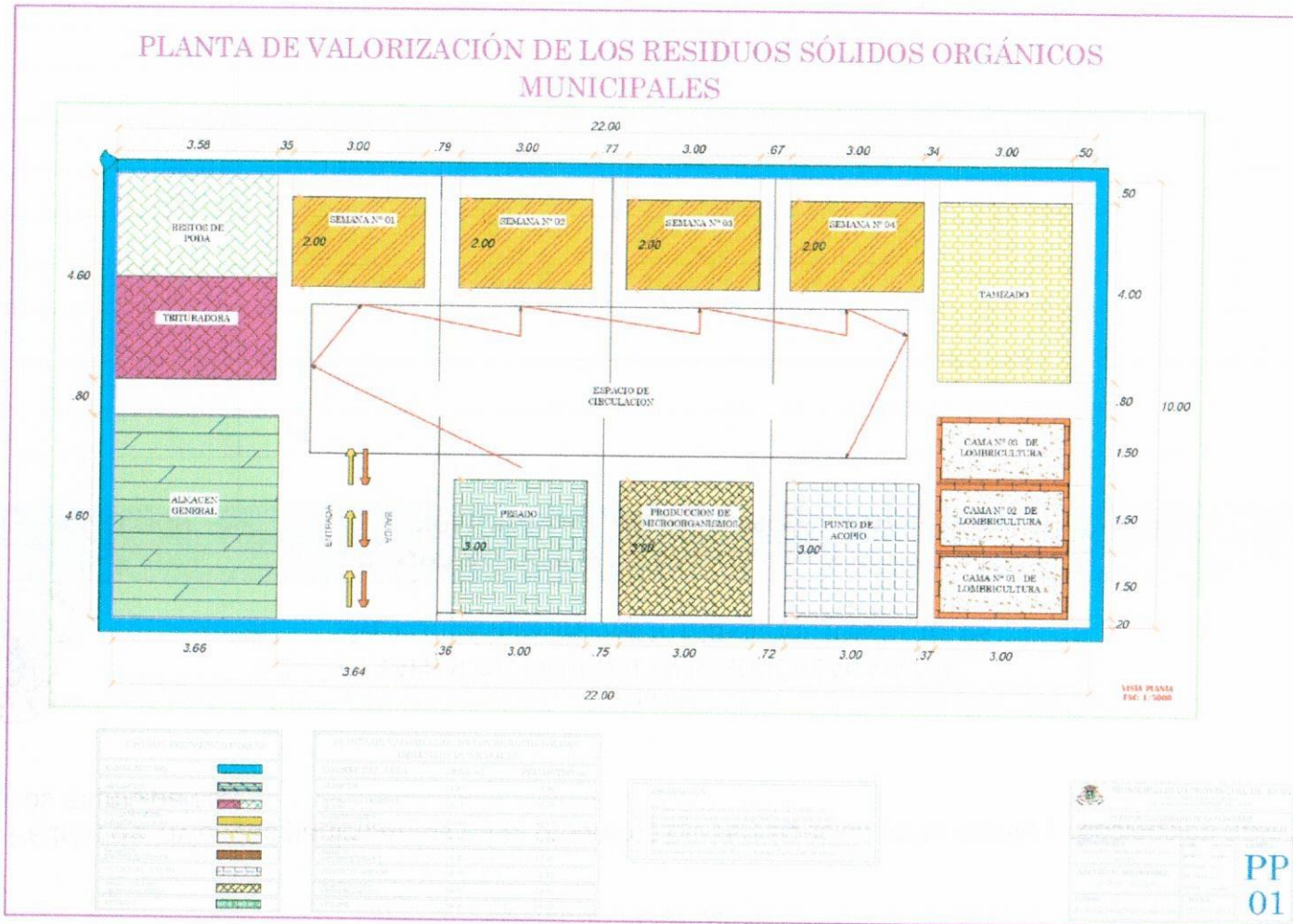
Anexo PP-01: Plano de distribución de la planta piloto de valorización de residuos sólidos orgánicos
